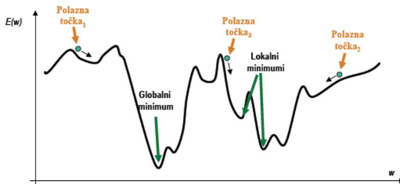
Slika 9. Grafički prikaz algoritma učenja Back propagation - lokalni i globalni minimumi.
